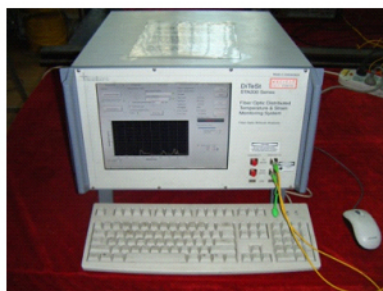
光纤传感解调设备（布里渊与光纤光栅信号）
