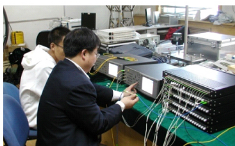
光纤传感解调设备（布里渊与光纤光栅信号）
