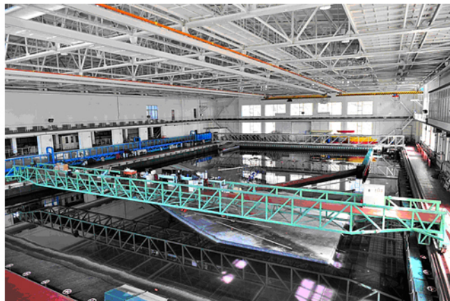
多功能三维波浪水池 (深水立管试验场地)
