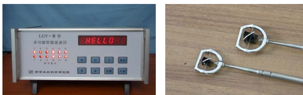
图 7 LGY—III型多功能智能流速仪
