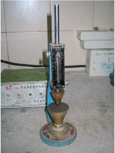
图 2-7 净浆标准稠度与凝结时间测定仪
