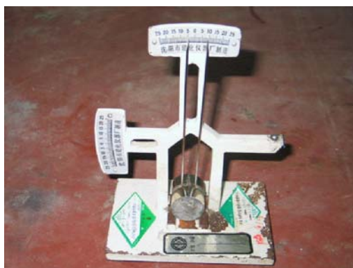
图 2-11 雷氏夹膨胀值测量仪
