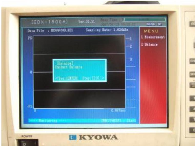
4、按任意键完成平衡操作，弹出屏幕监视框如下图。调整激励程度，当出现适合波形，则按红色 F<sub>4</sub> 键。
