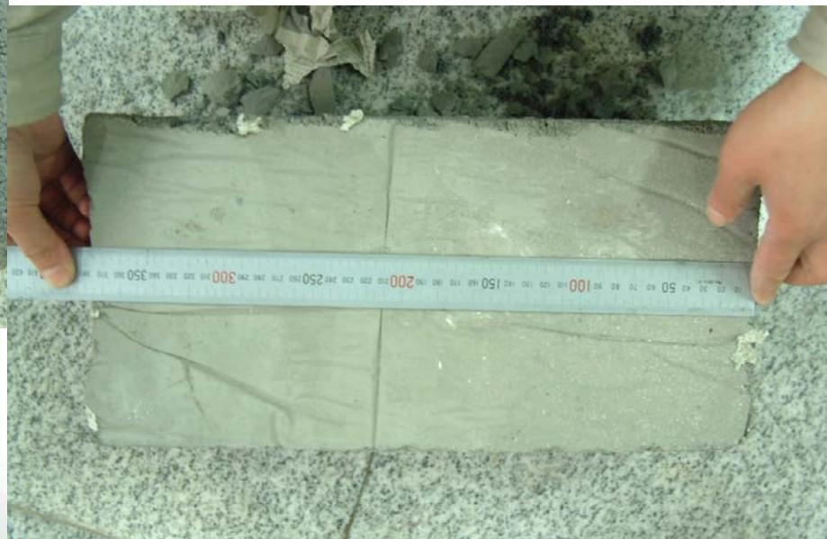
试件五个，测量每个试件的高度和宽度，分别求出各个方向的平均值。
