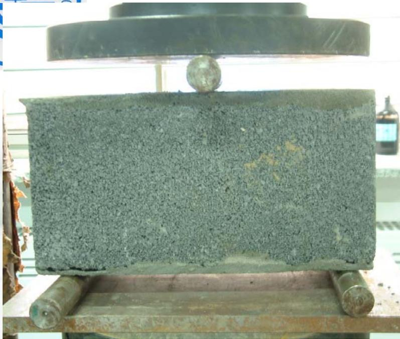
调整支座钢棒轴线间距等于试件长度减一个坐浆面的肋厚，中线与压力中心重合；坐浆面置于抗折支座；上部二分之一长度处放置一根钢棒。
