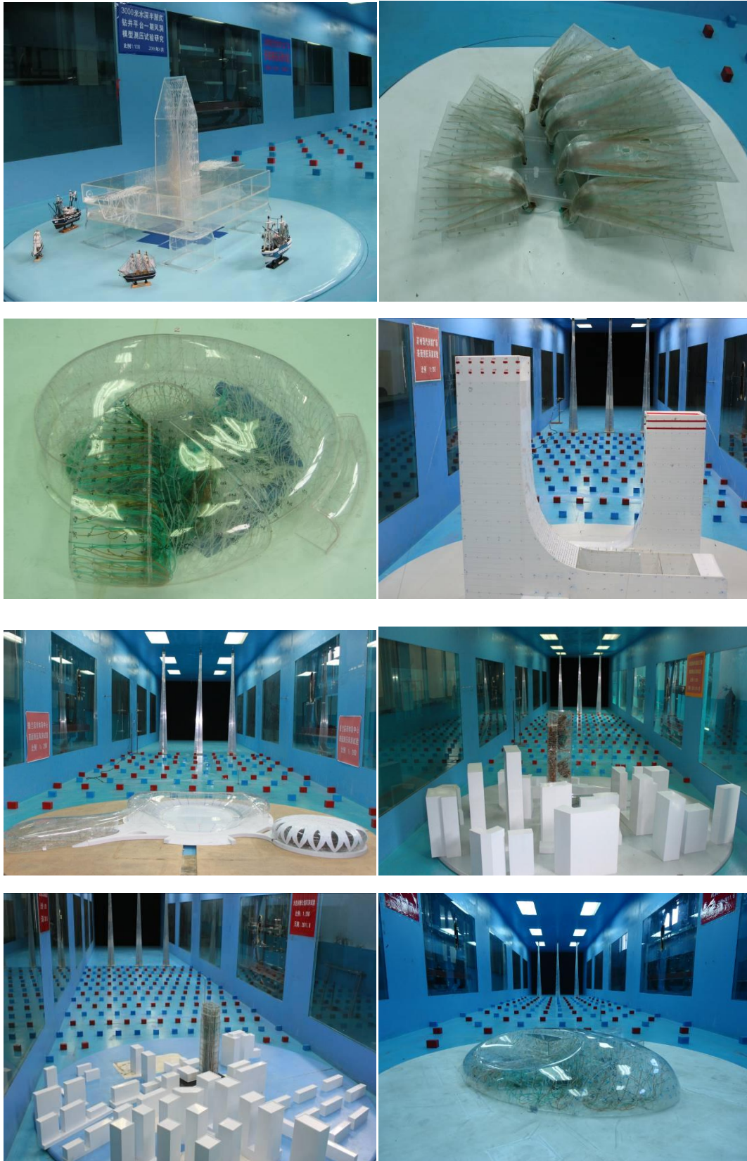
图 2-19 各种模型表面测压试验
