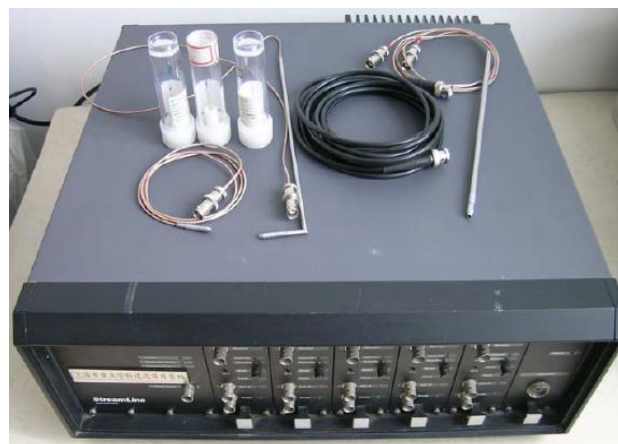
图 2-4 热线风速仪测量系统
