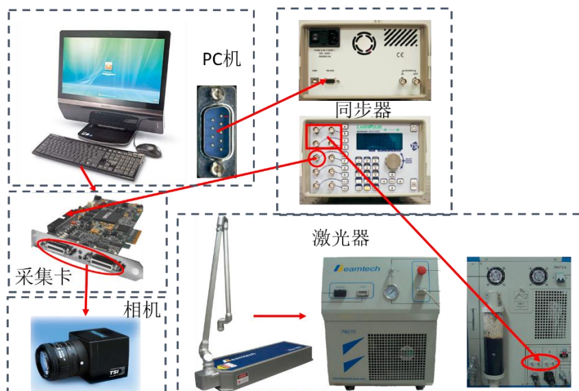
图 4-2 TSI 公司 PIV 系统连接图
